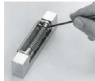
4. Ajuster la tension, puis insérer la goupille dans le trou
