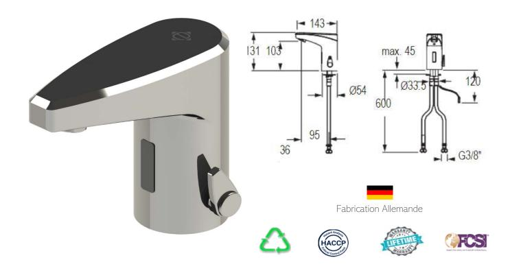
Robinet mitigeur électronique, alimentation batterie 6 V lithium CRP2 Capteur infrarouge adaptatif avec réglage automatique de la distance personnalisable Programme automatique de rincage antibactériens 30 s / 24 h après dernière utilisation Rincage par désinfection thermique
